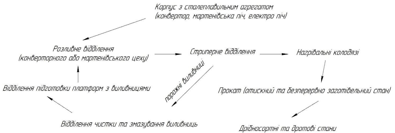
Рис.1. Схема технологічного процесу одержання заготовок традиційним способом
