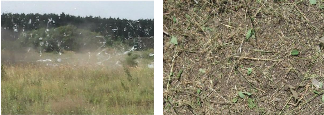
Рис. 8. Розліт продуктів детонації і оболонки заряду (ліворуч) та вид земної поверхні після вибуху(праворуч)
