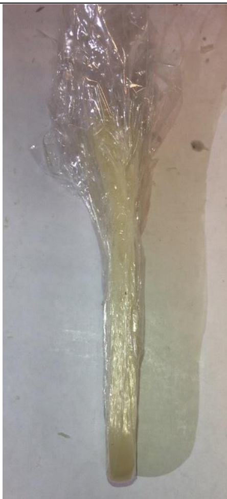
Рисунок 2 - Внешний вид заготовки после деформации на модели (в термостойкой пленке)
