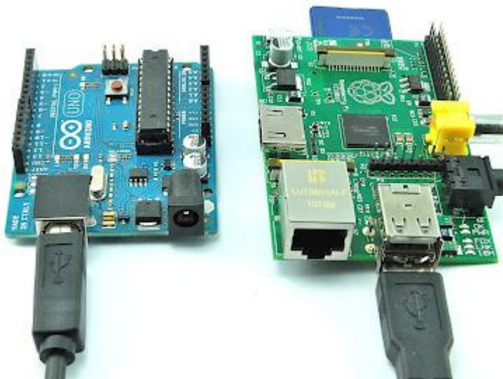
Рисунок 6 – Подключение Arduino к Raspberry Pi через USB
