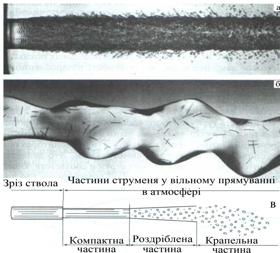
Рис. 1.3 Трансформація водяного струменя: а) фото компактної частини струменя; б) фото роздрібненої частини струменя; в) схематичне уявлення руху незатоплюваного струменя в повітрі
