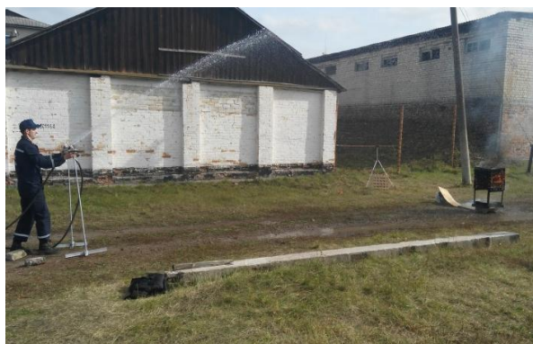
Рис. 4.3 Гасіння модельного вогнища 1А водою з використанням експериментальної установки АУГГУС-М: а) локалізація вогнища загорання; б) ліквідація горіння додатковим гасінням
