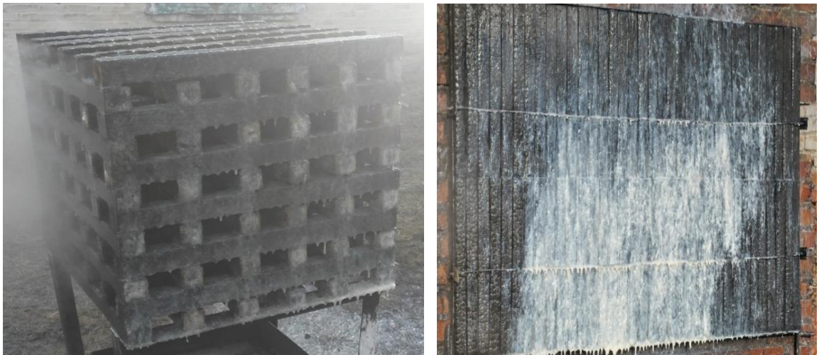
Рис. 2.21 Результат змішування компонент ГУС на третьому етапі руху двох струменів їх бінарних потоків, націлених на осередок пожежі по незалежним траєкторіям руху при гасіння палаючих об'єктів: а) розташованих на горизонтальній поверхні; б) розташованих вертикально або похило по відношенню до струменів бінарного потоку
