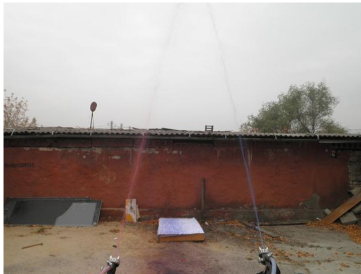
Рис. 2.18 Фото «прицілювання» стволів-розпилювачів для обох струменів складових ГУС ( \psi_1 = -\psi_2 ).
