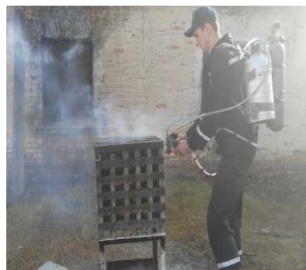
Рис. 4.3 Гасіння модельного вогнища 1А водою з використанням експериментальної установки АУГГУС-М: а) локалізація вогнища загорання; б) ліквідація горіння додатковим гасінням
