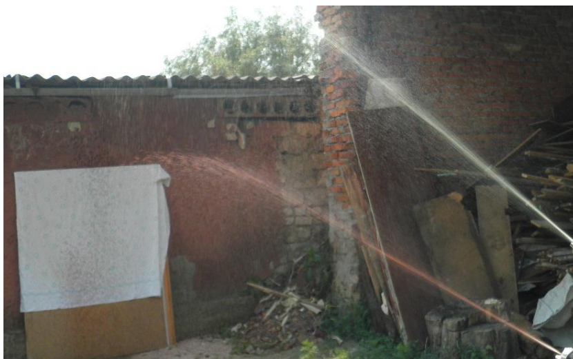
Рис. 2.16 Націлення ( \alpha_1 \approx \alpha_2 ) бінарних складових ГУС на мішень-екран, з метою уникнення передчасного утворення гелю при \Delta h = (h_1 - h_2) і \psi_1 = \psi_2 = 0
