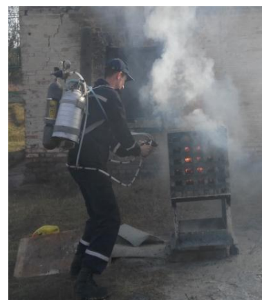
Рис. 4.4 Гасіння вогнища 1А: а) локалізація при дистанційній подачі компонент ГУС на 10 м; б) ліквідація горіння додатковим гасінням
