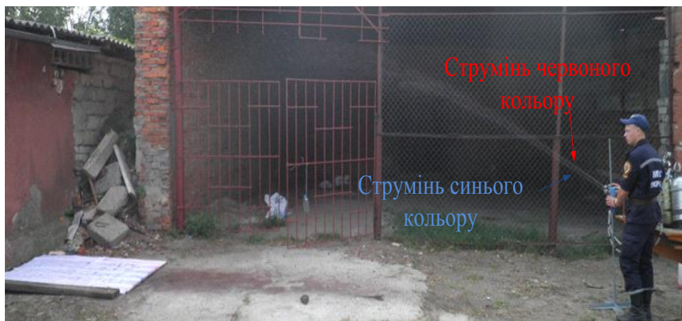
Рис. 2.15 Приклад подачі ВГР з передчасним змішуванням компонент ГУС, коли \alpha_1 = \alpha_2 , \psi_1 = \psi_2 = 0 та h_1 = h_2
