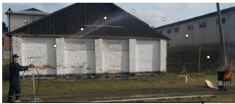
Рис. 2 – Формування експериментальних даних для аналітичної побудови траєкторій руху струменів, що подаються з установки АУГГУС-М
