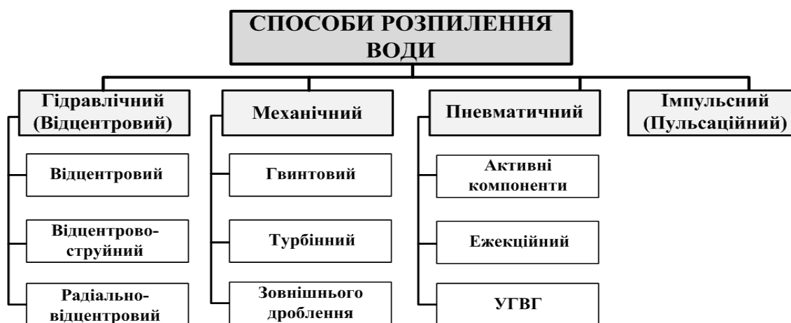
Рис. 2 – Способи розпилення води
