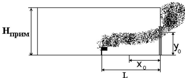
Рис. 4.2 – Схема визначення координати заданої точки під час розрахунку температури газового середовища у приміщенні
