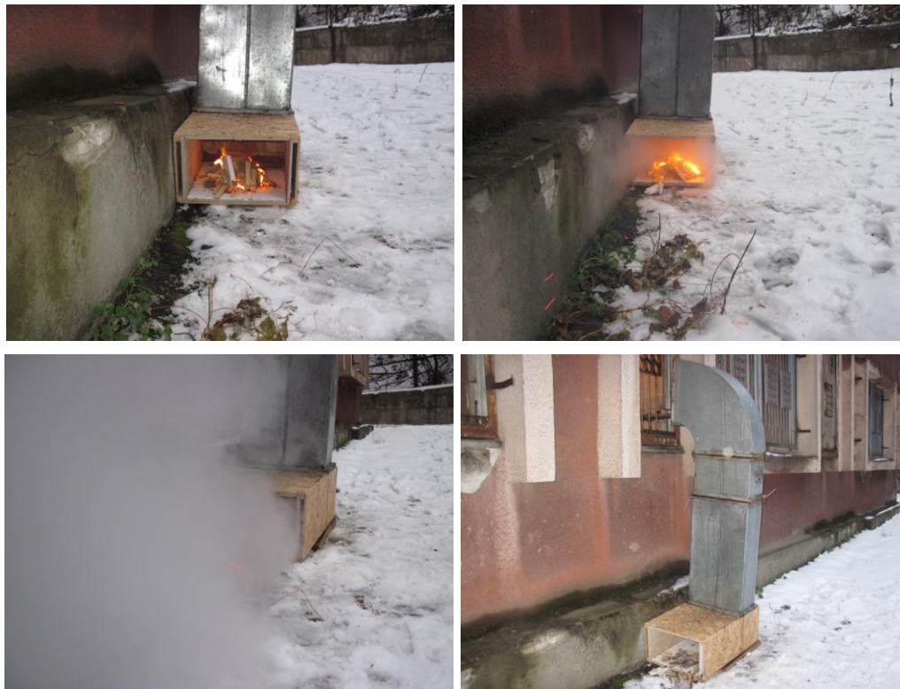
Рис. 4. Результати проведення експериментальних досліджень щодо гасіння осередку пожежі в приміщенні складної конфігурації
