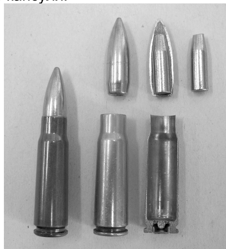
Рис. 1. Загальний вигляд унітарних патронів і особливості конструкції їхніх елементів спорядження
