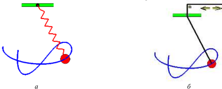
Рис. 1 Аналогія між кутовими коливаннями: а – хитної пружини; б – математичного параметричного маятника.
