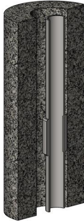
Рис 1. Тримірна модель бурильного замка та масиву гірської породи
