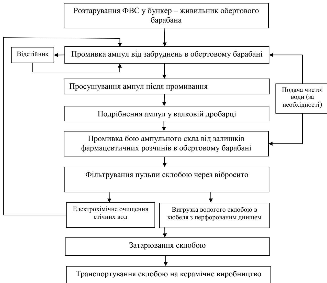
Рис. 1. Принципова схема підготовки ФВС для утилізації у виробництві керамічної плитки
