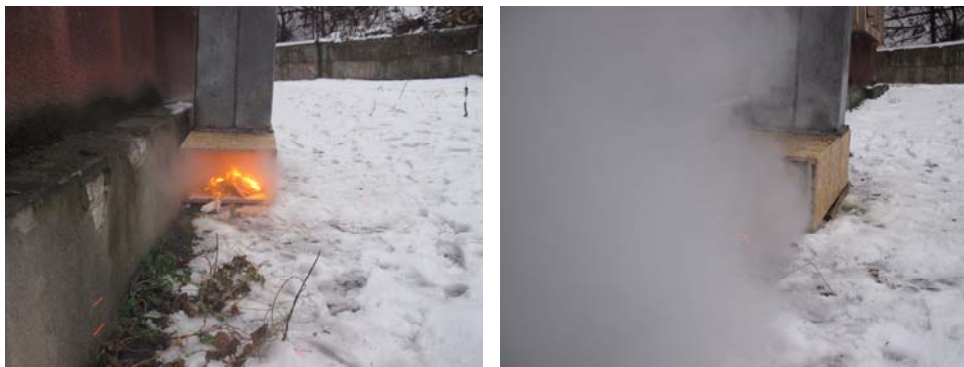
Рисунок 3 – Результаты проведения экспериментальных исследований тушения пожара в помещении сложной конфигурации
