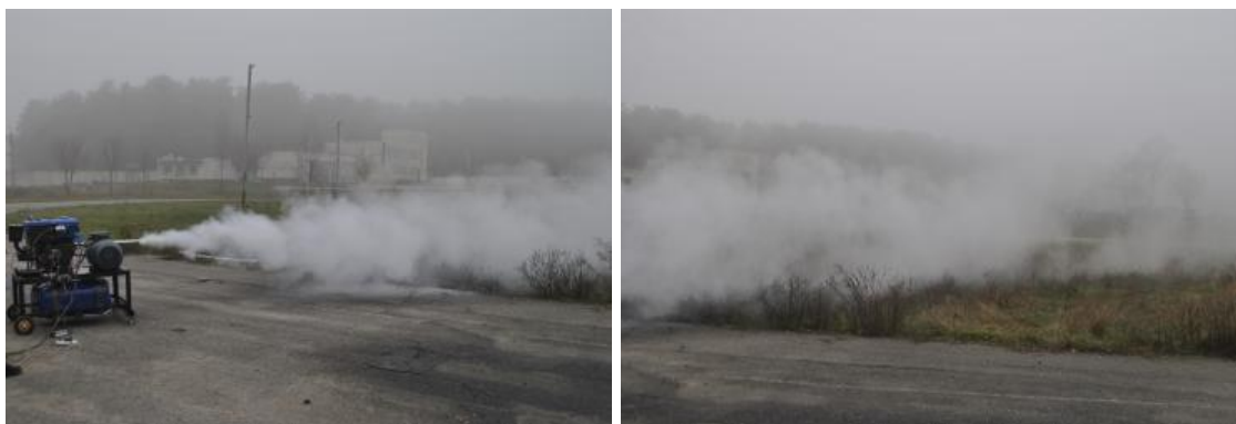
Рис. 2. Результати проведення експериментальних досліджень щодо визначення довжини та висоти розповсюдження струменя водяного аерозолі
