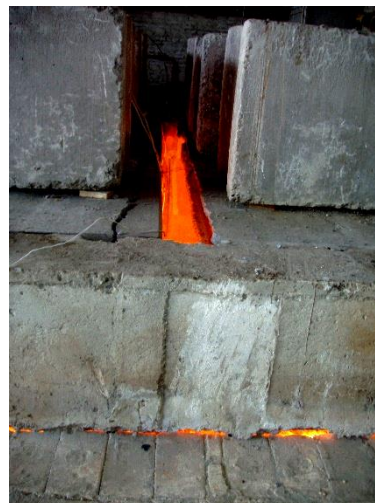
Рис. 5 Зона обвалення зразка №2
