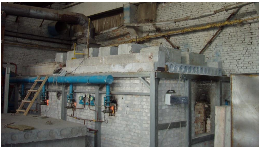
Рис. 4 Вигляд зразків на печі під навантаженням
