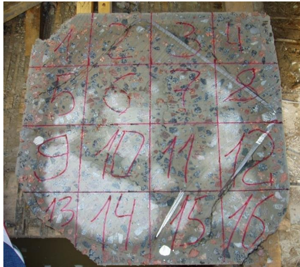
Рис. 13 Розрізання колони після випробувань
