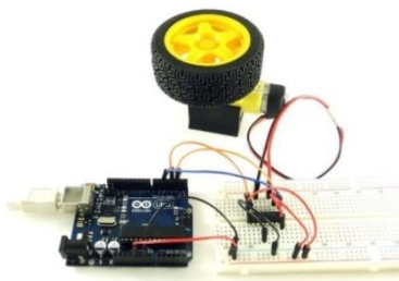
Рис. 3. Підключення двигуна постійного струму, мікросхеми L293D і плати Arduino Uno
