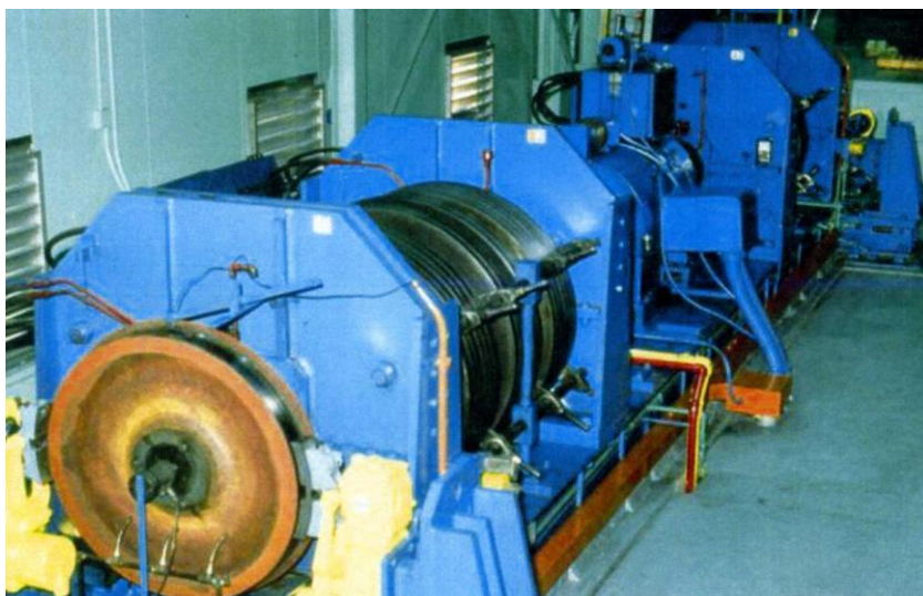
Рис.1. Инерционный стенд для испытания колодок
