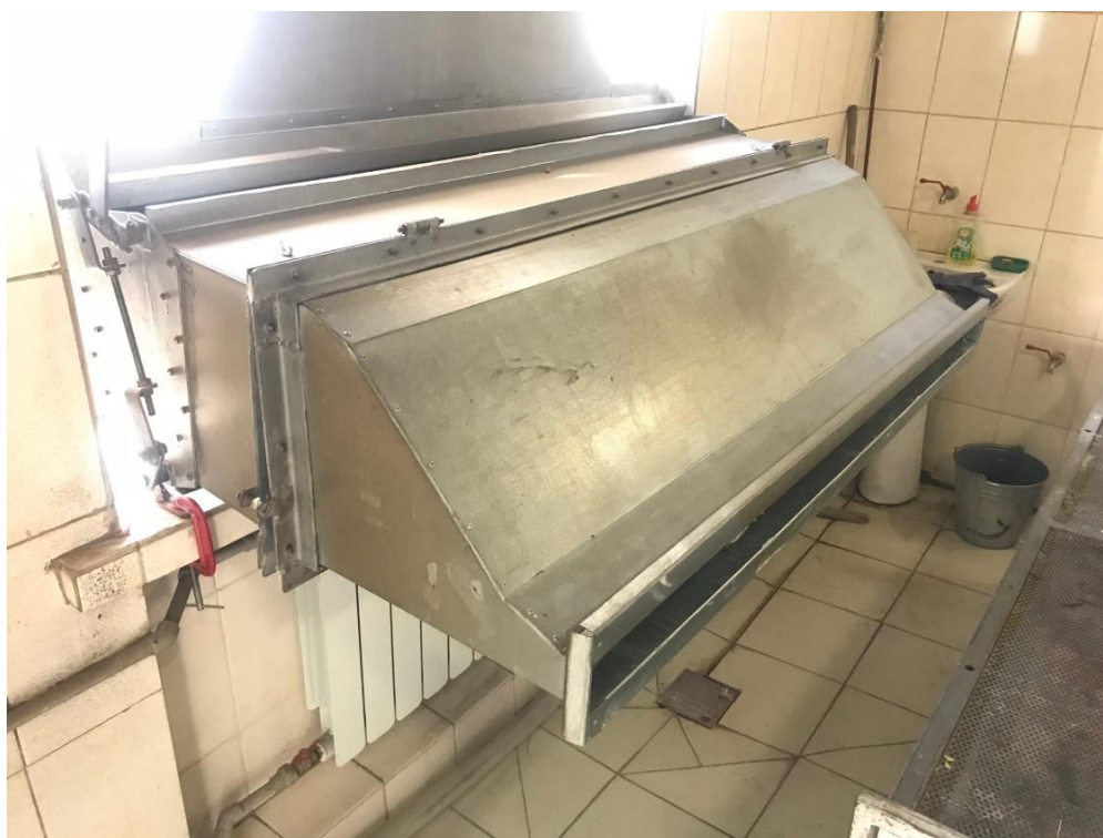
Рис. 3. Установка для імітації потоку повітря з різною швидкістю з опущеним соплом
