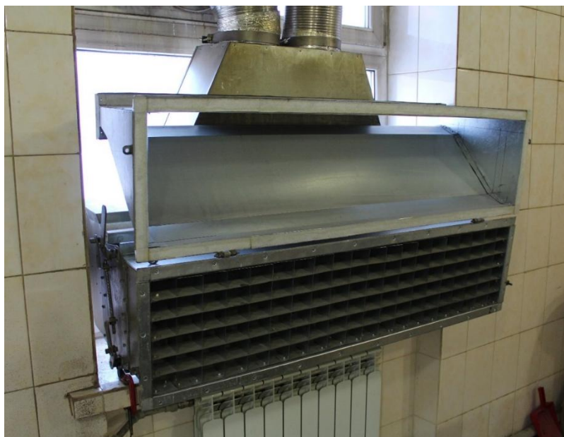
Рис. 2. Установка для імітації потоку повітря з різною швидкістю з піднятим соплом
