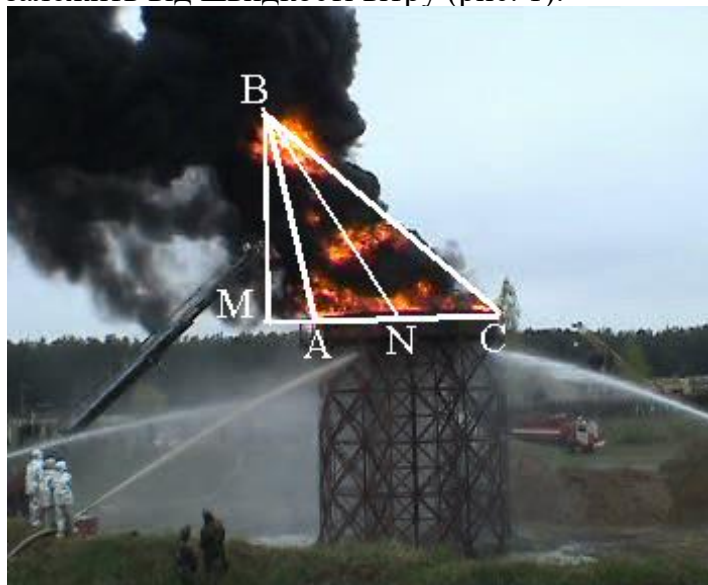
Рис. 1. Параметри факелу: ABC – конус факела; BN – довжина факела; BM – висота факела; \angle MBN = \alpha – кут нахилу конуса відносно вертикальної вісі
