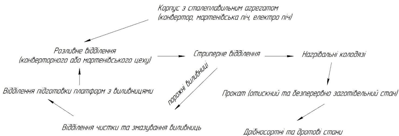
Рис.1. Схема технологічного процесу одержання заготовок традиційним способом
