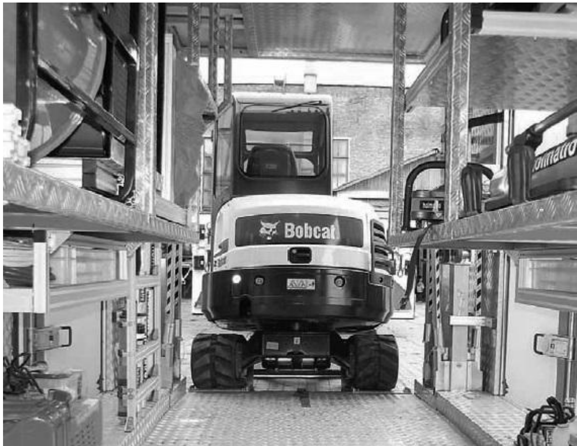
Рисунок А.11 – Кузов-контейнер мобільного аварійно-рятувального комплексу «Граніт» виробництва ТОВ «Велмаш-С» (Російська Федерація), оснащений мініавантажувачем Bobcat-T770
