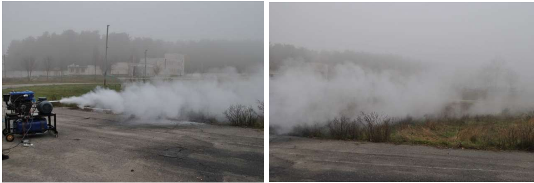
Рисунок 1. Результати проведення експериментальних досліджень щодо визначення довжини та висоти розповсюдження струменя водяного аерозолію.
