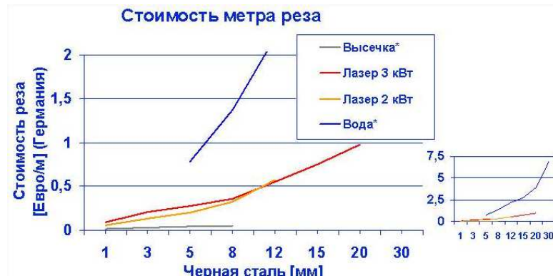
Рис. 6. Зависимость стоимости метра реза различных методов в зависимости от толщины разрезаемого материала
