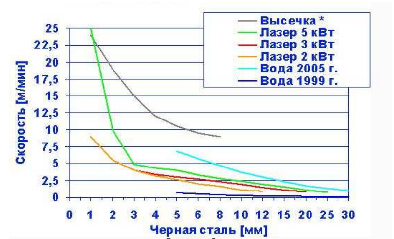
Рис. 4. Зависимости скорости резки от способа резки и толщины исходного материала
