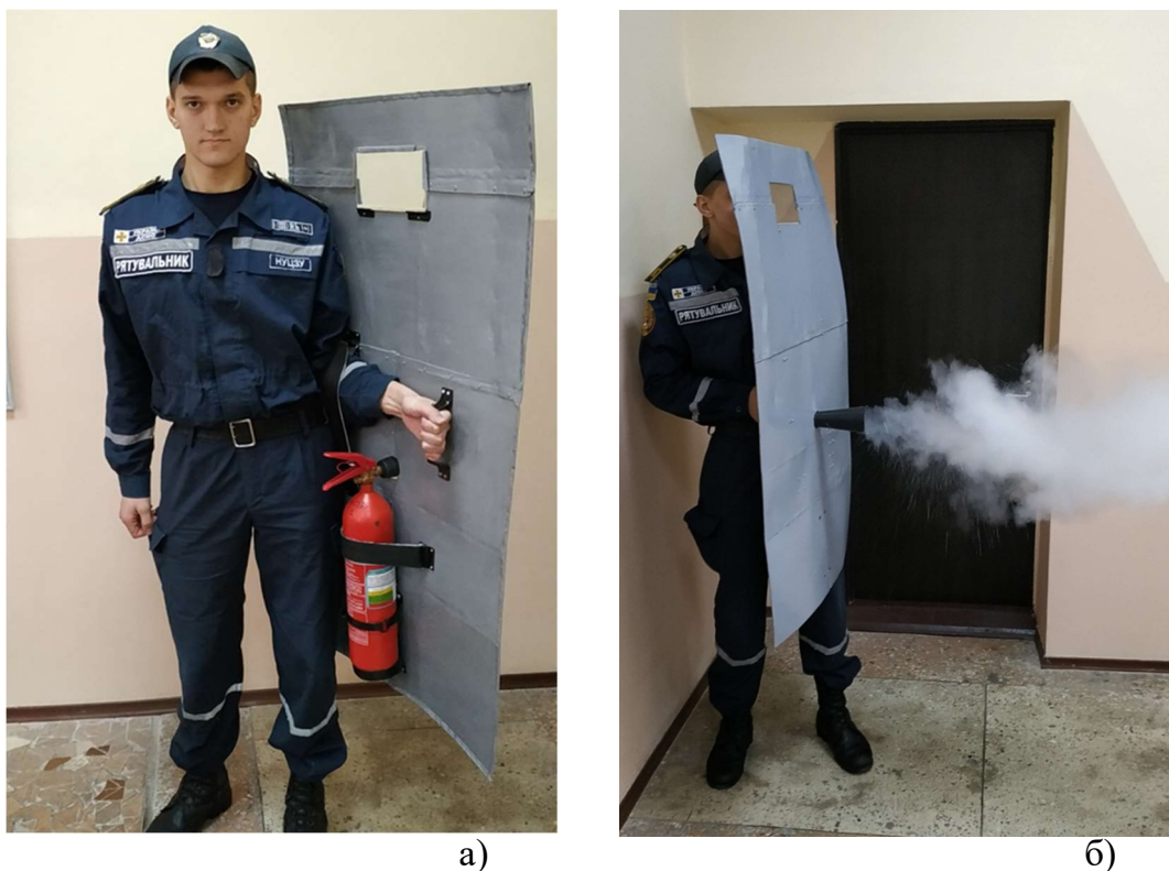
Рисунок 1. Зовнішній вигляд та принцип роботи щита-вогнегасника а) Вигляд щита-вогнегасника зсередини; б) Вигляд щита-вогнегасника ззовні.
