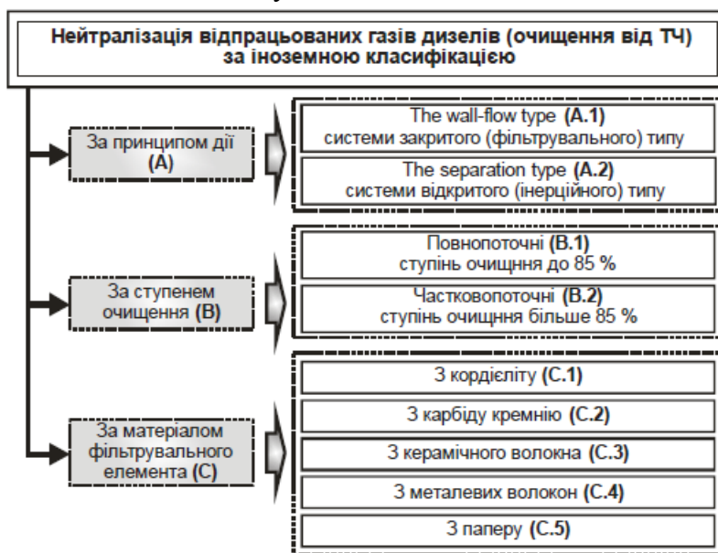
Рис. 1. Іноземна класифікація пристроїв для очищення потоку ВГ дизельних ДВЗ від ТЧ, систематизована авторами монографії [1]
