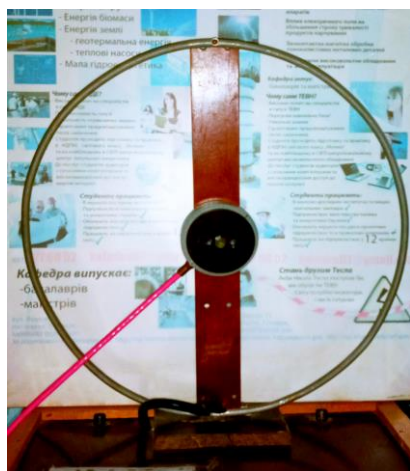
Рисунок 1 – Індукційний перетворювач для вимірювання імпульсного магнітного поля
