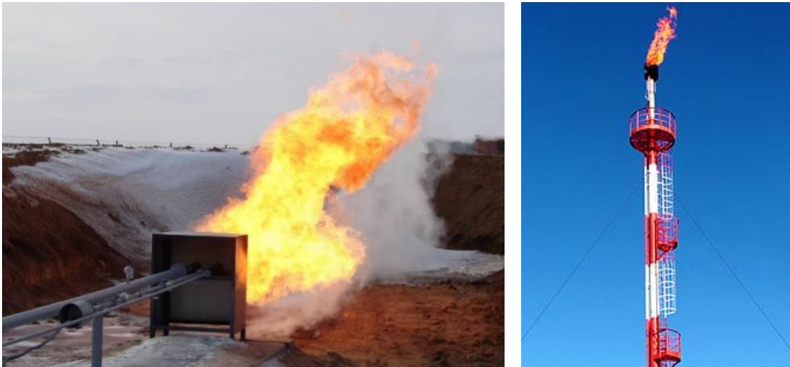
Рисунок 1. Факельні стволи горизонтального та вертикального розташування
