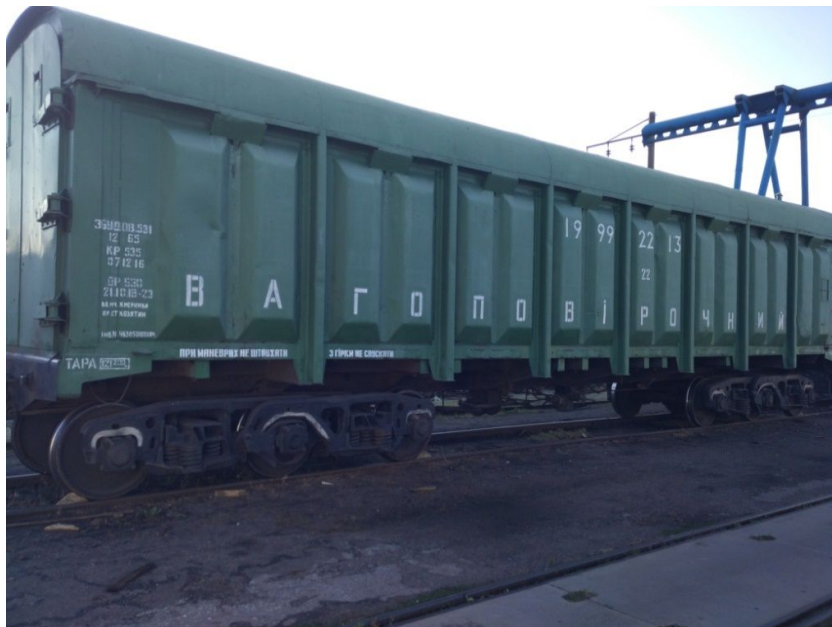
Рис. 2 Вагоповірочний вагон ВПВ-640 з візками УВЗ-9М
