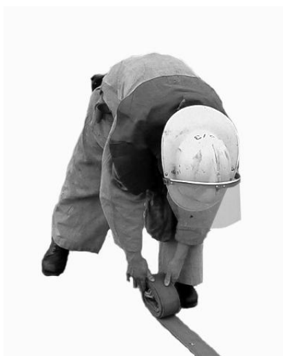
Рисунок 5.27 – Змотування "Н" в одинарну скатку
