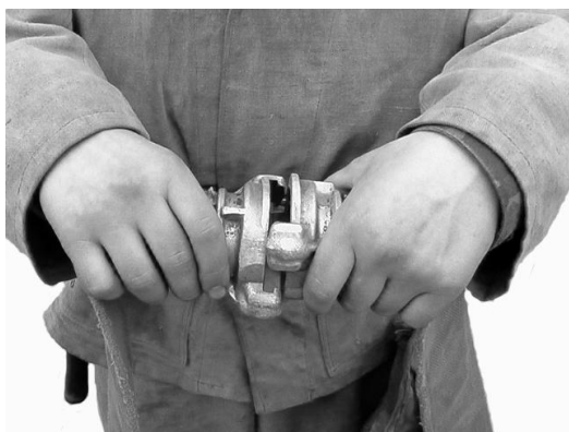
Рисунок 5.29 – З'єднання головок "Богдан"
