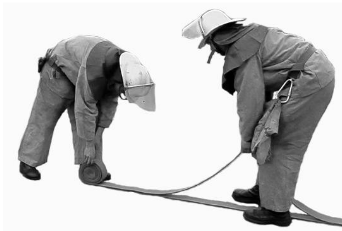
Рисунок 5.28 – Змотування "Н" в подвійну скатку
