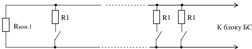
Рис. 4.5 – Схема подключения безадресных контактных датчиков (известителей) в адресный шлейф сигнализации через четырехканальные блоки сопряжения
