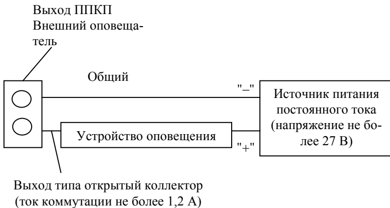
Рис. 2.23 – Схема подключения ППКП "Алай П-16"
