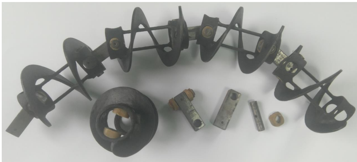
Рисунок 1 – Загальний вигляд секцій робочого органу, розташованого на криволійній ділянці та його окремих елементів
