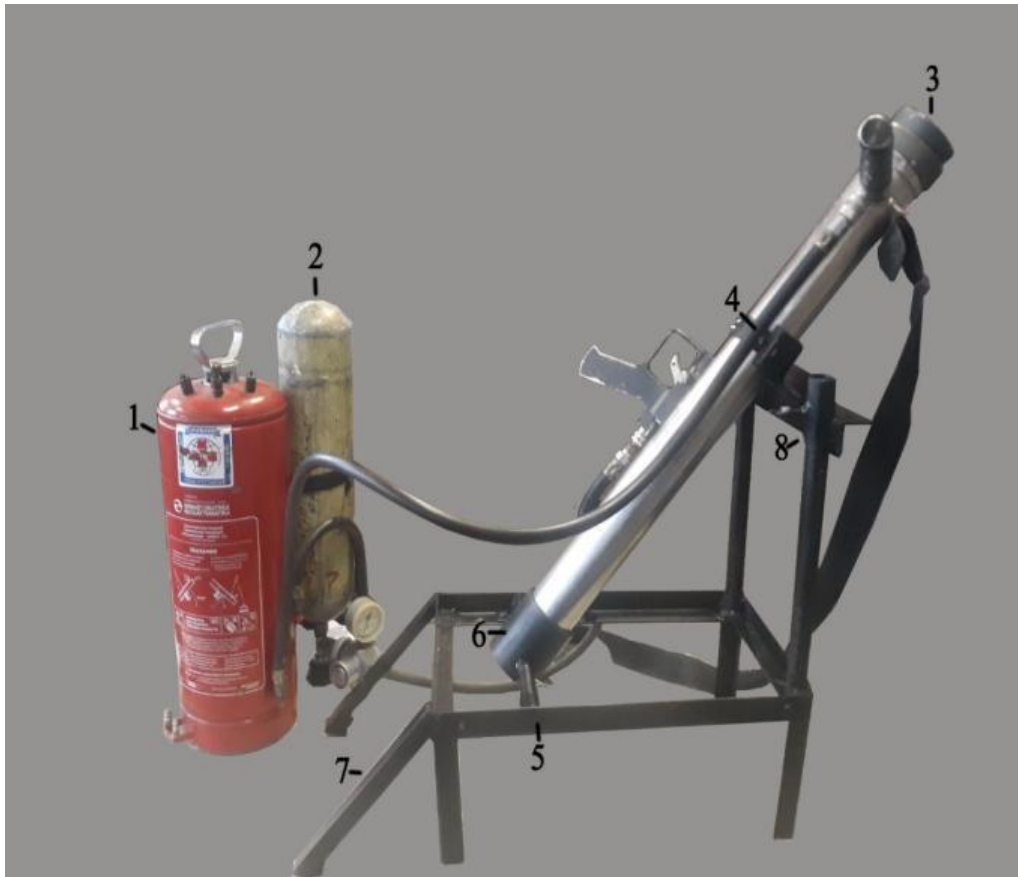
Рис. 1. Лафет та імпульсний вогнегасник «ТАЙФУН-10» 1. Балон для рідини. 2. Балон з стиснутим повітрям. 3. Ствол. 4. Фіксатор ствола на лафеті. 5. Основа лафета. 6. Опора для ствола. 7. Упори. 8. Стійкі для переміщення фіксатора ствола по вертикалі.
