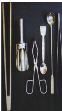
Рисунок 1. Відповідні матеріали для відбору проб твердих речовин (зліва направо): щипці дерев'яні, лопатка, тигельні щипці, ложка-лопатка мала, ложка шпатель велика, щипці.
