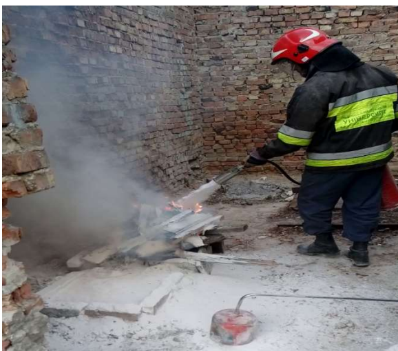
Рисунок 1. Гасіння комбінованої пожежі деревини і магнію після подавання порошку піною підвищеної стійкості
