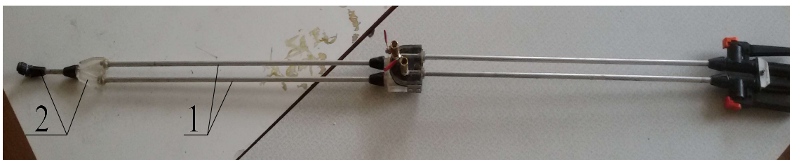
Рисунок 2. Подовжений колінчастий ствол установки гасіння гелеутворюючими складами
