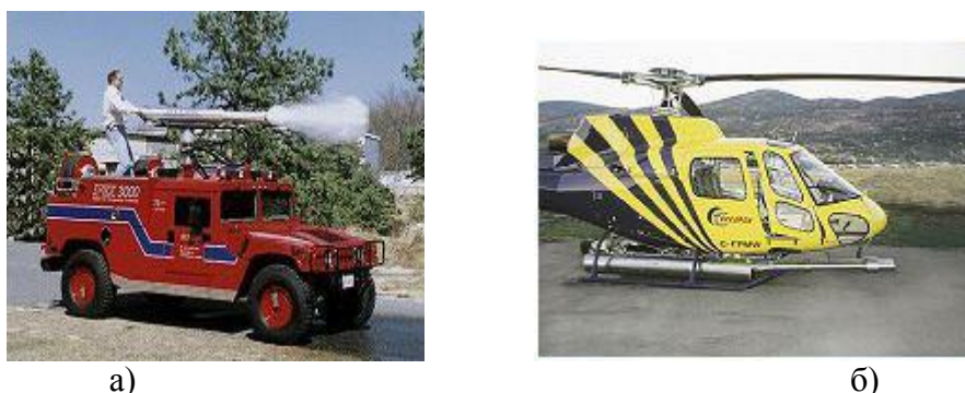
Рис. 2. Мобільні пневматичні установки імпульсного пожежогасіння: а) IFEX FireHunter, б) IFEX Helicopter
