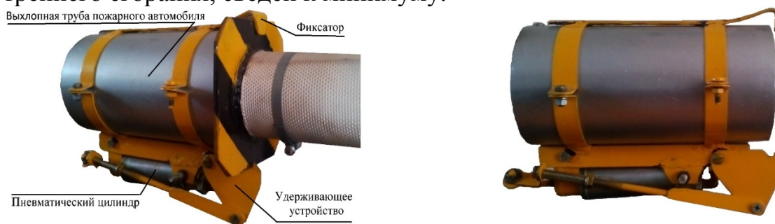
Рисунок 5 – Пневматический саморазмыкатель газоотвода от выхлопных труб пожарных автомобилей
