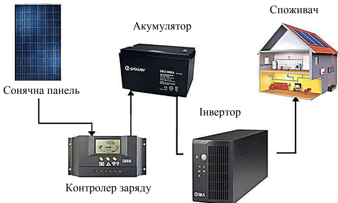
Рис. 1. Схема принципу роботи сонячної панелі
