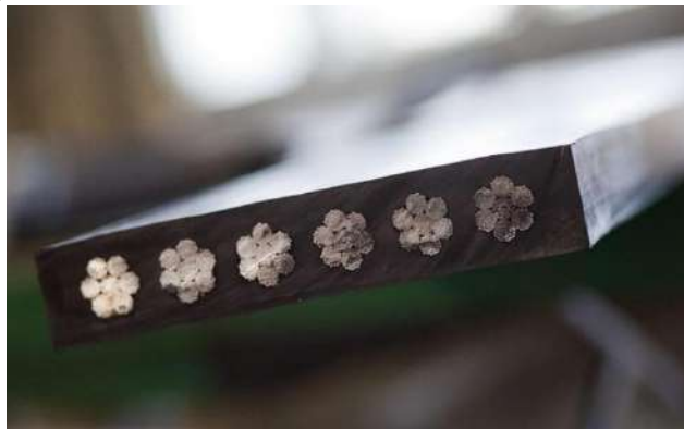
Рис. 1. Гнучкий тягово-несучий орган у вигляді гумотросового каната
