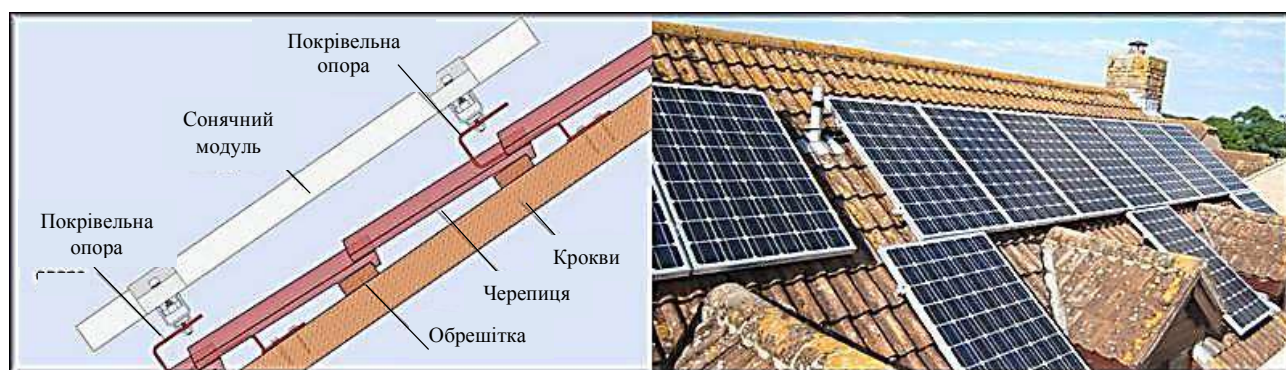
Рис. 2. Схема кріплення сонячної панелі до конструкції даху з черепицею
