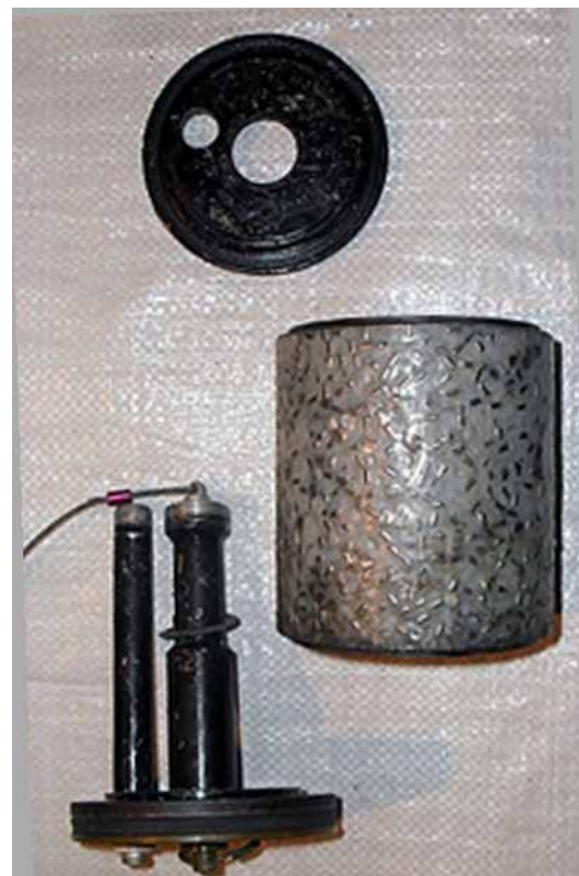
Рисунок 1.1 – 108 мм осколкова загороджувальна міна ОЗМ-72 (ГРАУ – 57-МПН-383) вагою 5,0 кг: 1 – накольний механізм (ударник; бойова пружина) УМ; 2 – вишибний заряд (ДРП-1 = 0,007 кг.); 3 – втулка з КЗ (КВ-11) УМ; 4 – ніпель (втулка) з КВ-11 і кулькою ВШМ; 5 – трубка (алюмінієвий сплав) ВШМ; 6 – пробка зі скобою під КД №8 УМ; 7 – камера (сталевая); 8 – додатковий детонатор (А-ІХ-1 або Тетрил = 0,023 кг.); 9 – кришка сталевая; 10 – стакан сталевий; 11 – втулка (алюмінієвий сплав) УМ; 12 – сталеві циліндрики (ГВЕ) залиті компаундом – 2400 шт.; 13 – дно (сталь); 14 – натяжний трос сталевий; 15 – пробка (ковпачок) алюмінієвий під УМ (МУВ-4 без запалу); 16 – гумова прокладка; 17 – картонна прокладка; 18 – прокладка (пароніт); 19 – прокладка (пластина губчата); 20 – гайка (алюмінієвий сплав); 21 – гайка (сталевая); 22 – шайба (сталевая); 23 – поліетиленова оболонка обойми під циліндрики; 24 – ВР (Т = 0,66 кг)
