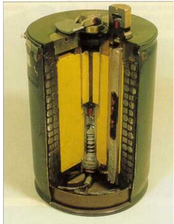
Рисунок 1.3 – 108 мм ОЗМ-72: 1 – вишибний заряд (ДРП-1 = 0,007 кг); 2 – трубка; 3 – направляючий стакан; 4 – втулка з КЗ і кулькою ВШМ; 5 – ковпачок; 6 – пробка; 7 – кришка; 8 – заряд ВР (Т = 0,66 кг); 9 – корпус з блоком ГВЕ = 2400 шт.; 10 – додатковий детонатор (тетрил = 0,023 кг); 11 – втулка; 12 – втулка з КЗ (КВ-11) УМ; 13 – ударник, 14 – бойова пружина; 15 – кришка, 16 – натяжний трос; 17 – клиновидний замок; 18 – запобіжний ковпачок; 19 – камера
