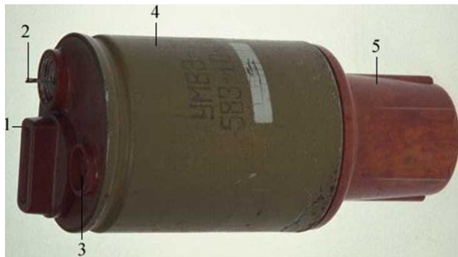
Обривний датчик з НМ: 1 – дріт; 2 – корпус; 3 – ТНРС; 4 – ЕЗ; 5 – ударник; 6 – МД-5М
