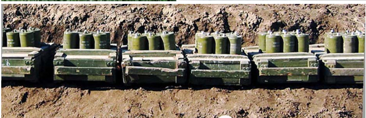
Рисунок 1.8 – 108 мм ОЗМ-72 у ящику 66x60x23 см: Міни упаковуються в ящики по 6 шт. (маса брутто 54 кг) неостаточно спорядженими (без підривників МУВ і капсулів-детонаторів №8А, якими міна споряджається на місці установки). Проте підривники і капсулі детонатори укладаються в ящик на заводі
