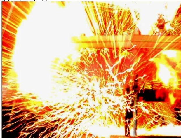
Рис. 2. Начальная стадия ЭВ медной жилы сечением S_1 \approx 3,2 \text{ мм}^2 ОО радиочастотного коаксиального кабеля марки РК 50-7-11
