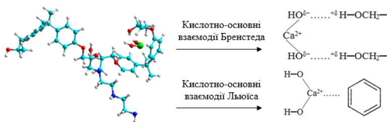
Рис. 1. Моделювання кислотно-основних взаємодій між фрагментом епоксiamінної полімерної сітки та поверхнею кальцій гідроксиду
