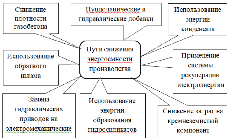
Рис. 1. Некоторые пути снижения энергоёмкости производства автоклавного газобетона
