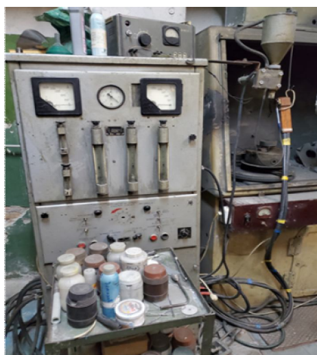
Рисунок 6 - Установа «УПУ-3Д» з плазмотроном ПП-25 і порошковим дозатором, зліва камера для напилення з вертикальним обертачем
