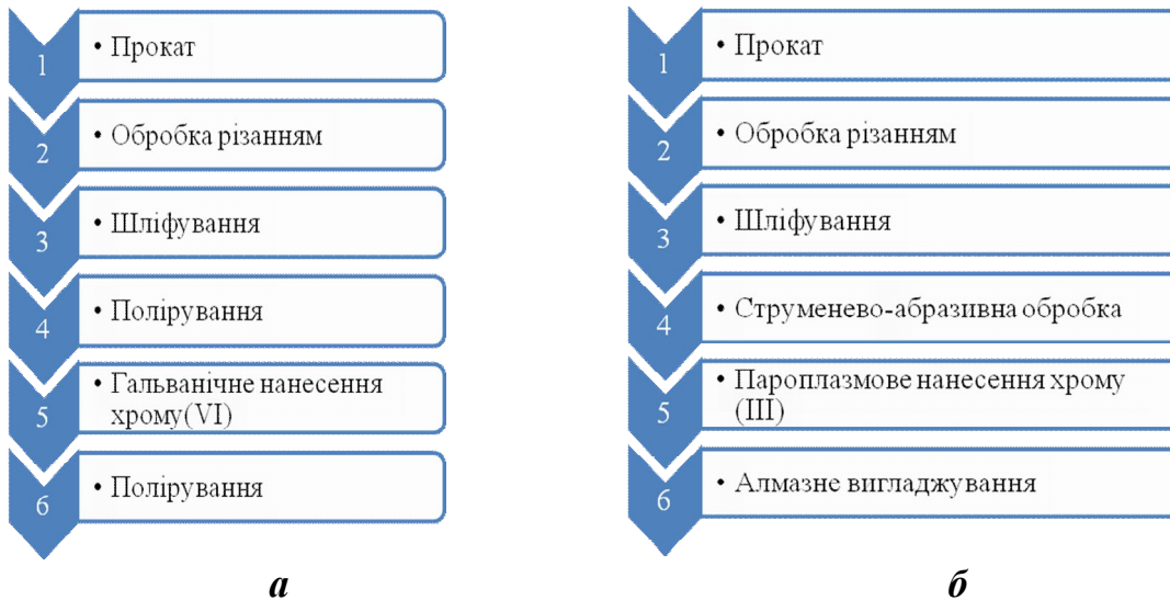
Рисунок 1 - Схема підготовки поверхні валу відцентрового насоса (стал X12МФ):
