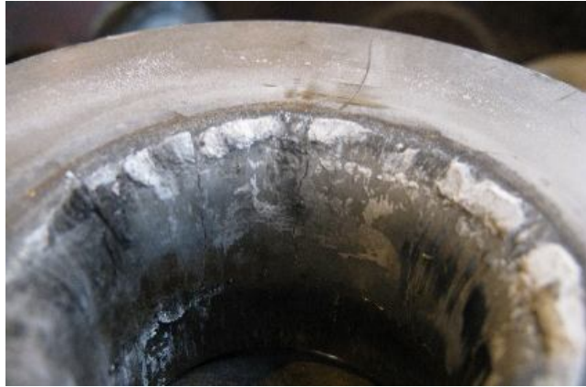
Рисунок 1 – Картина зносу матриці трубопрофільного пресу
