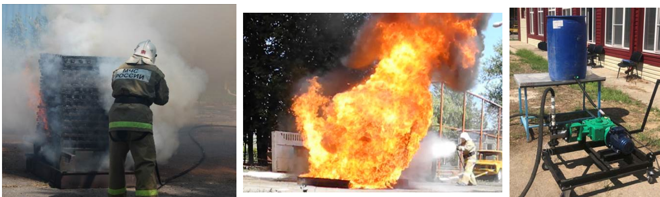
Рисунок 2 – Поверхностное тушение модельных очагов струями ТАВ с ингибирующими свойствами
