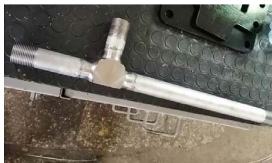
Рисунок 1 – Используемый в экспериментальном исследовании дозатор и смеситель
