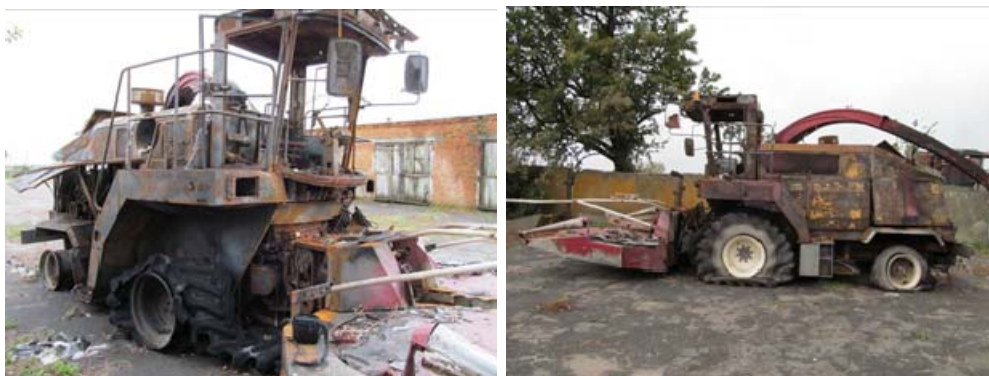
Рисунок 1. – Общий вид термических повреждений комбайна «КВК-800»
