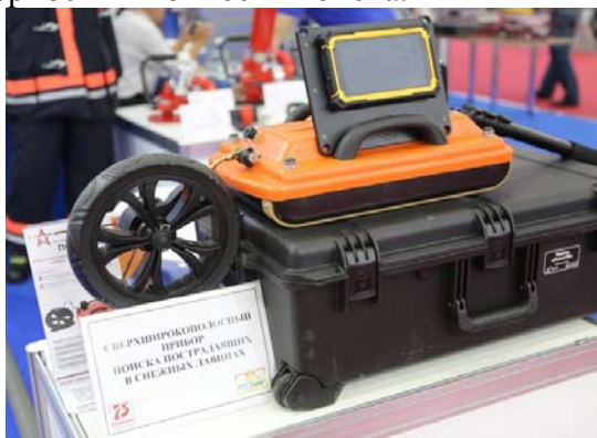
Рис. 1 Мобильный комплекс для поиска пострадавших в снежных завалах и лавинах «Поиск - ПЛ»
