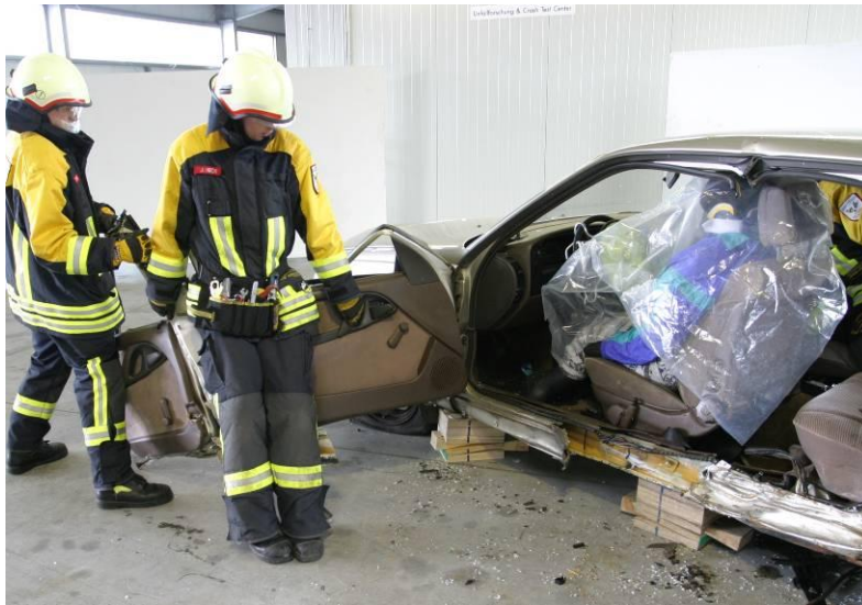
Рис. 2 Видалення обох дверей зі сторони постраждалого
