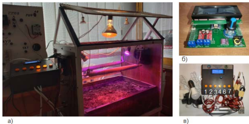
Рис. 1. Загальний вигляд розробленого і виготовленого пристрою: а) пристрій автоматичного керування мікроклімату з макетом теплиці; б) вигляд макетної плати з припаяними пристроями; в) загальний вигляд розробленої і виготовленої установки автоматичного керування
