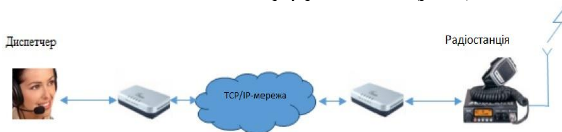
Рис. 1. Схеми організації зв'язку радіостанції з пультом дистанційного управління через IP-мережу
