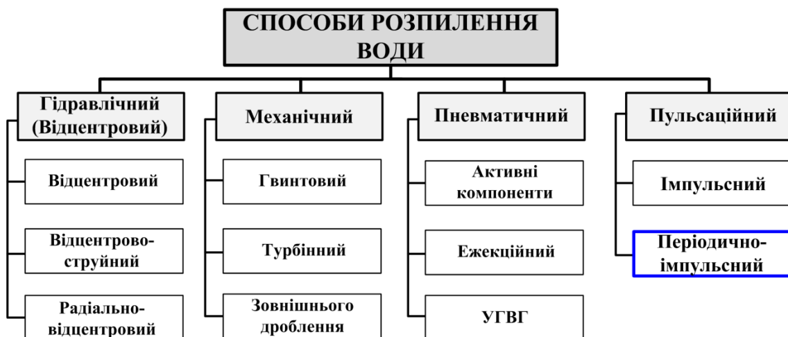
Рис. 1. Класифікація способів розпилення води
