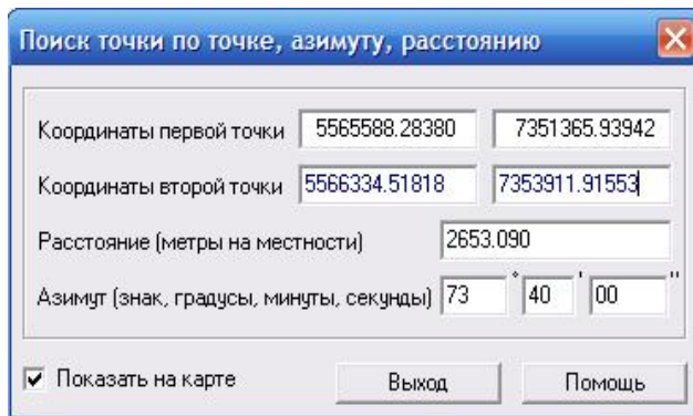
Рис. 3. Діалогове вікно визначення координат точки Р на карті
