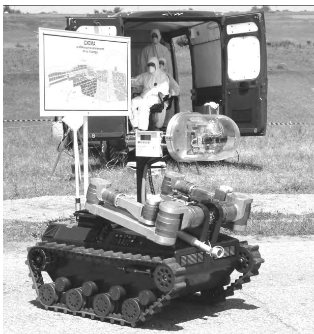
Рис. 1 - Робот для спасательных работ и обезвреживания взрывоопасных предметов
