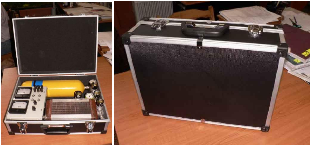
Рисунок 5. Рабочий образец металлгидридного источника электроэнергии для работы техники в полевых условиях.
