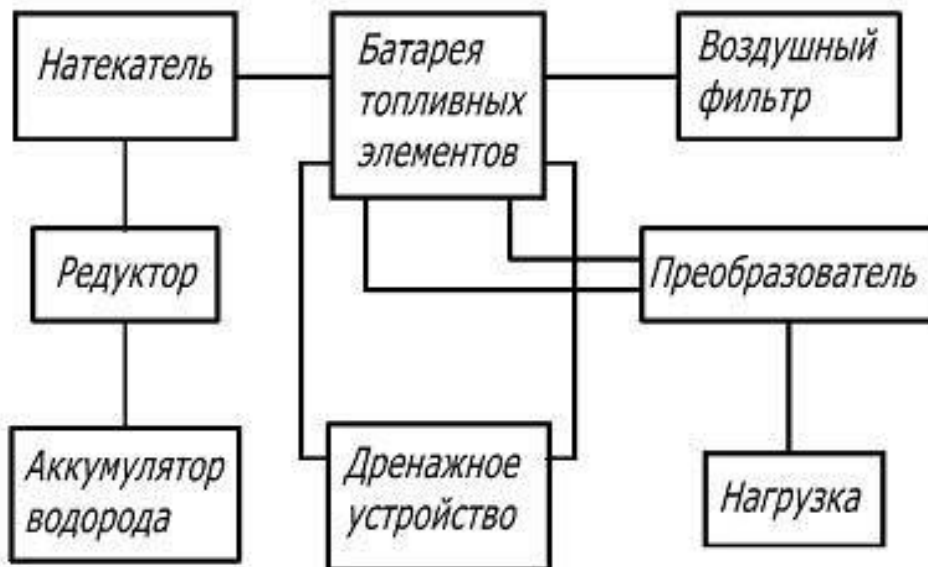
Рисунок 4. Блок-схема аварийного водородного источника электроэнергии.
