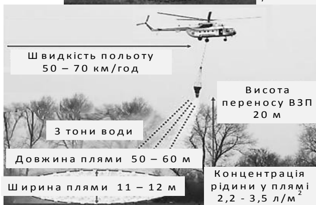
Рисунок 1 – Режим польоту при зливі вогнегасної рідини та параметри утвореної плями (а – літака, б – з водозливного пристрою гелікоптера)
