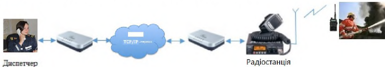
Рис. 1 – Організація каналу зв'язку з віддаленим пунктом управління через IP-мережу.
