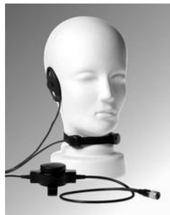
Рис. 14.5 – Принцип застосування ларингофонів
