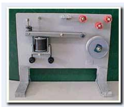
Рис. 20.3 – Зконструйований найпростіший телеграфний передавач
