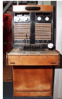
Рис. 15.3 – Міжміський телефонний комутатор М-60 (1970 р)
