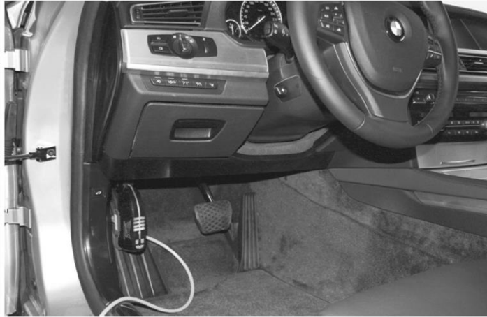
Рисунок 1. Приєднання до діагностичної системи за допомогою одного роз'єму (ICOM A)
