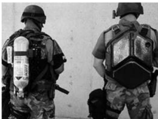
Рисунок 2. Сравнение стандартного баллона ИДА и воздушных пакетов Slim-systems (вид сзади)
